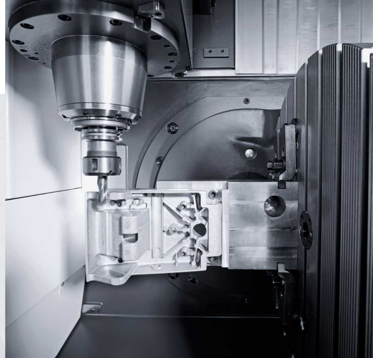
Serraggio tavola idraulico e carico tavola massimo di 350 kg (CMX 70 U)
