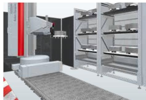
Durante il trasporto del pallet, il robot si porta in una posizione che garantisce minimo ingombro e stabilità.
