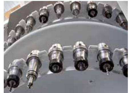
Ampliare la riserva di utensili è facilissimo grazie a un magazzino Rotary per portautensili.
