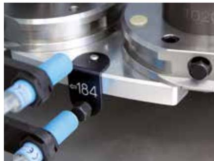
Ogni posto magazzino e ogni pallet vengono sorvegliati costantemente. A tenere tutto sotto controllo ci pensa il sistema di riconoscimento EWIST™ Rapid.
