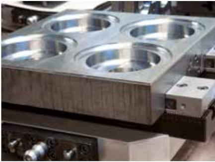
I pallet vengono allestiti in base al pezzo. Morsa, attrezzo o piastra sotto vuoto, i sistemi di serraggio EROVA tengono tutto saldamente con grande rigidità.
