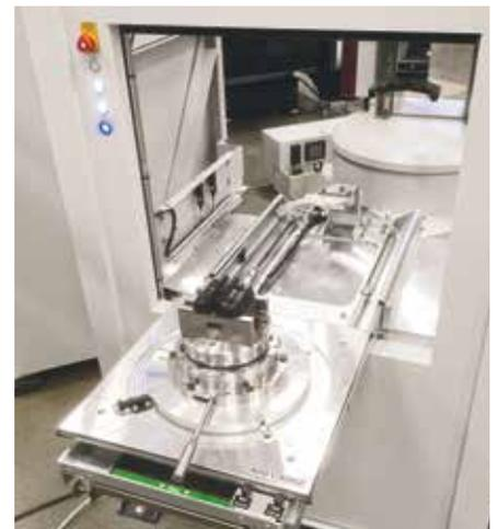
Tramite la "stazione di attrezzaggio e carico 150" (opzione) dalla struttura agile ed ergonomica, i pezzi su pallet con dimensioni max. di 400x400x400 mm e un peso di trasferimento di max. 150 kg vengono trasferiti senza fatica nella cella di produzione. Durante l'attrezzaggio un robot continua a lavorare senza problemi in questo intervallo.
