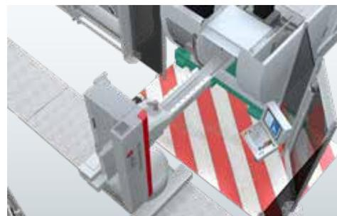
La grande portata del braccio del robot di ben 2.350 mm consente di lasciare libero un ampio spazio per l'operatore davanti alla macchina.
